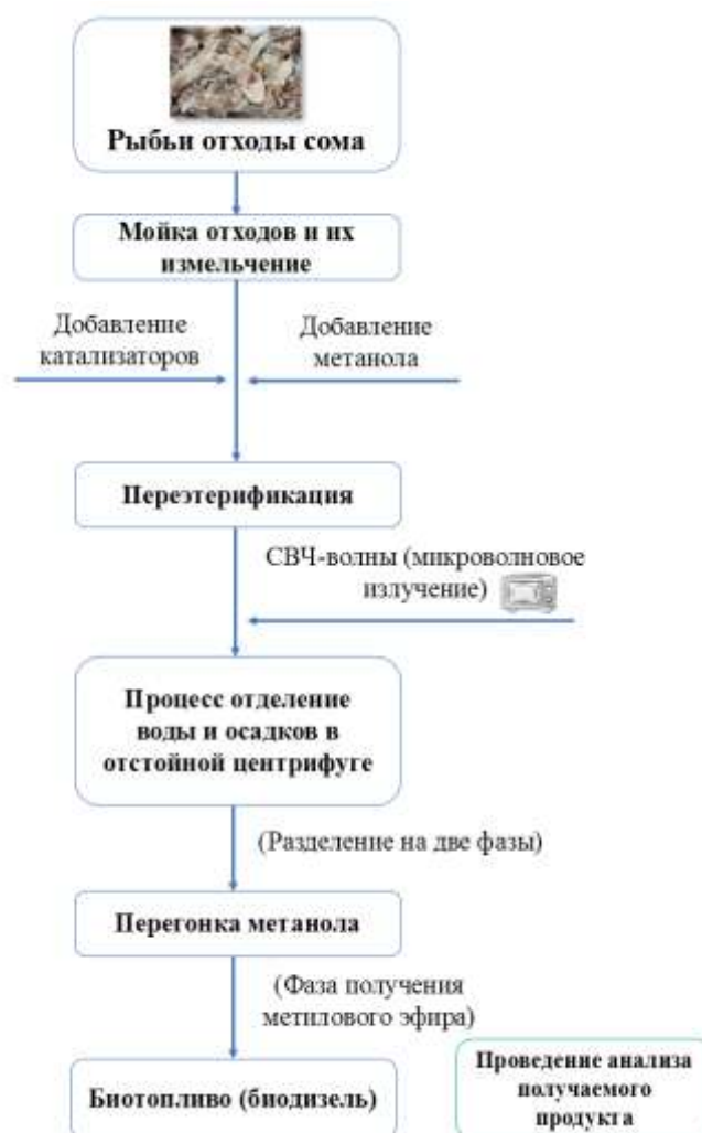
Рисунок 2 – Процесс производства биодизеля из рыбьих отходов [8]
