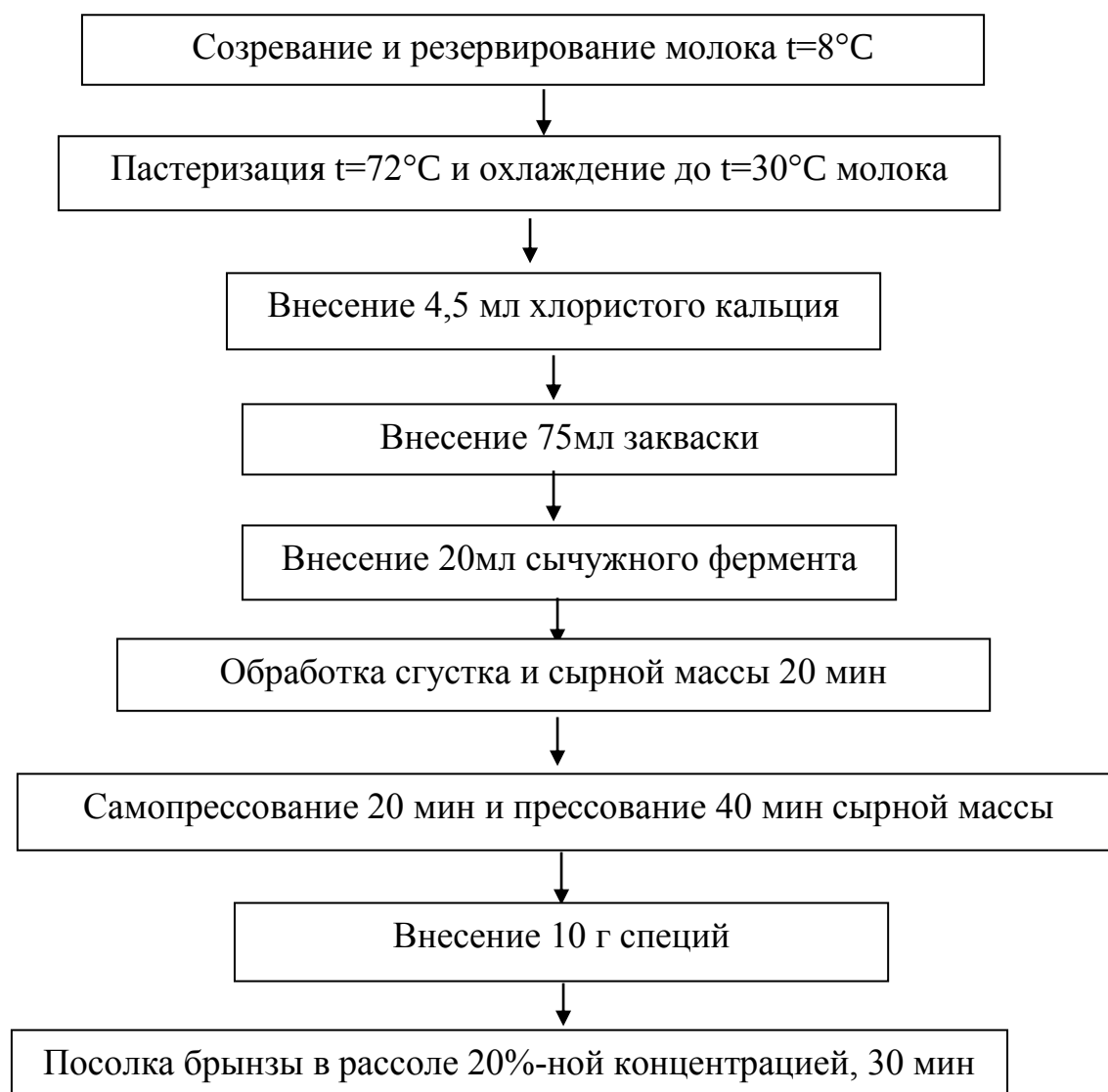
Рисунок 1 – Схема производства брынзы
