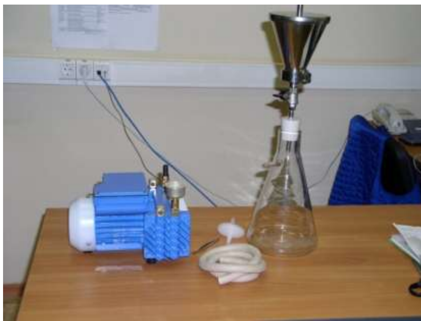
Рисунок 1 – Односекционная установка мембранной вакуумной фильтрации
