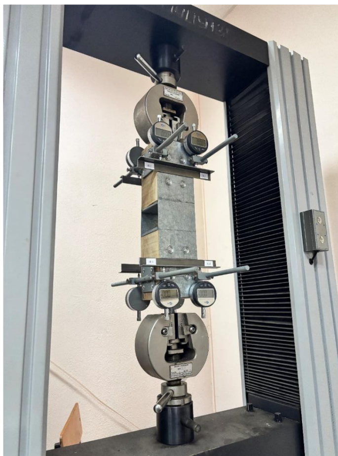
Рисунок 2 – Испытание опытного образца в разрывной машине в лаборатории кафедры СК
