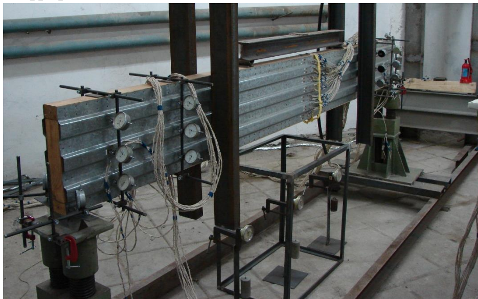
Рисунок 2 – Деревометаллическая балка со стенкой из профилированных листов на испытательном стенде в лаборатории кафедры СК
