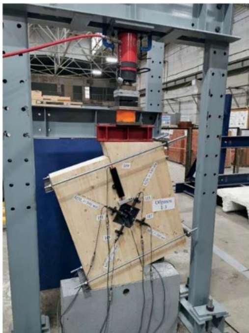
Рисунок 6 – Испытание на сдвиг узла стыка диафрагм и дисков жесткости на клеевинтовых стержнях в лаборатории НИЦ «Строительство» (ЦНИИСК им. В.А. Кучеренко)
