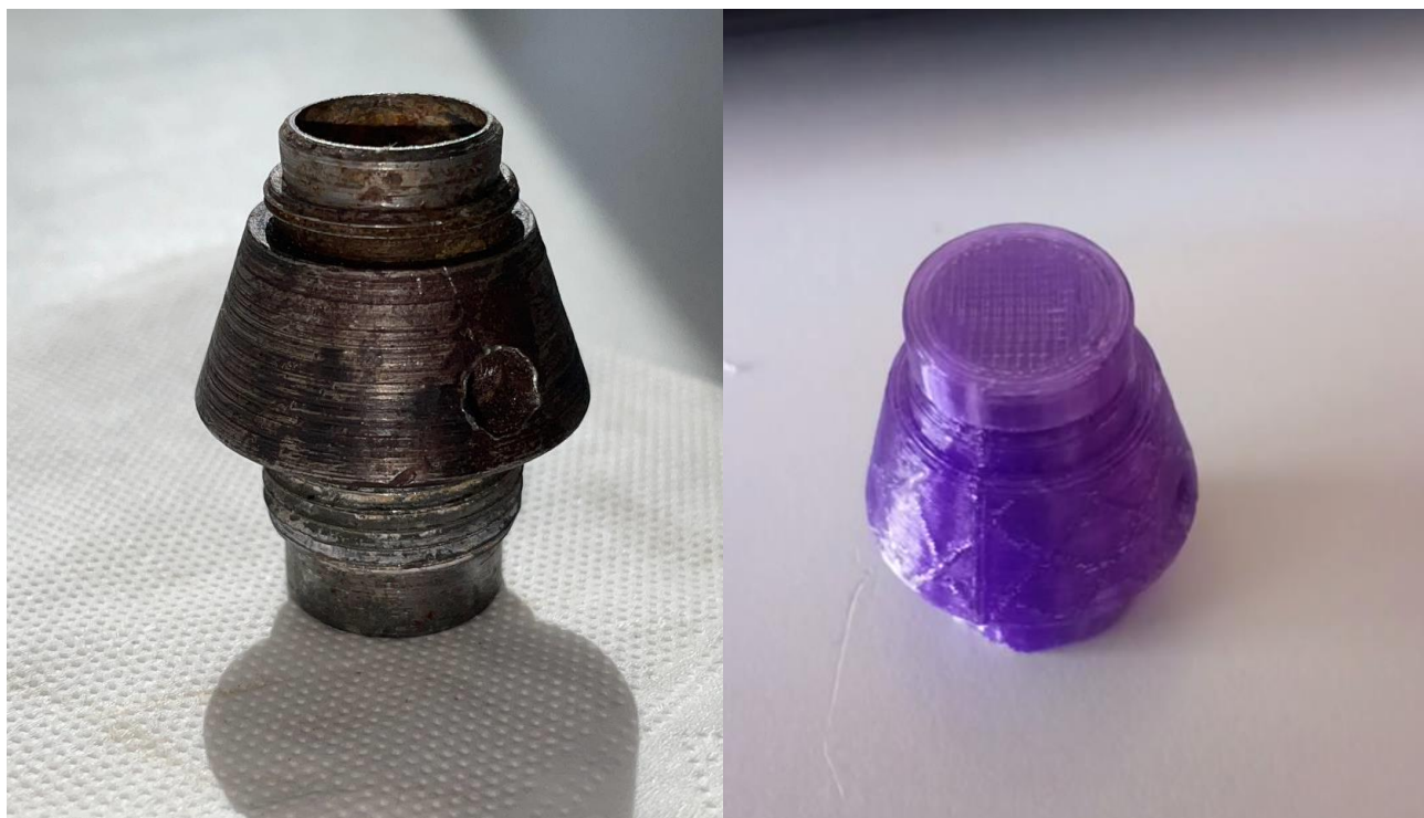
Рисунок 2 – Головная втулка взрывателя КТМ-2 и его модель, выполненная на 3D-принтере
