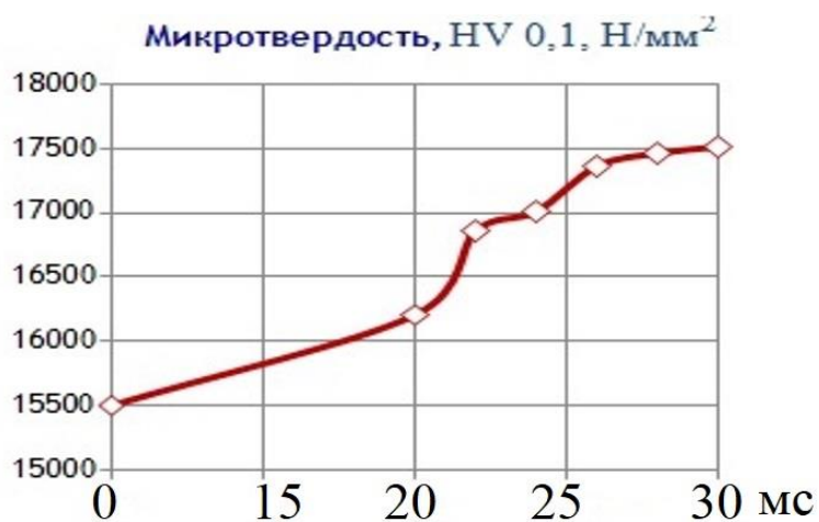
Рисунок 6 – Микротвердость после лазерной обработки
