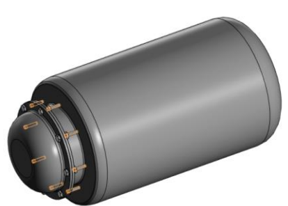
Рисунок 1 – Пример проектируемого топливного бака ракеты
