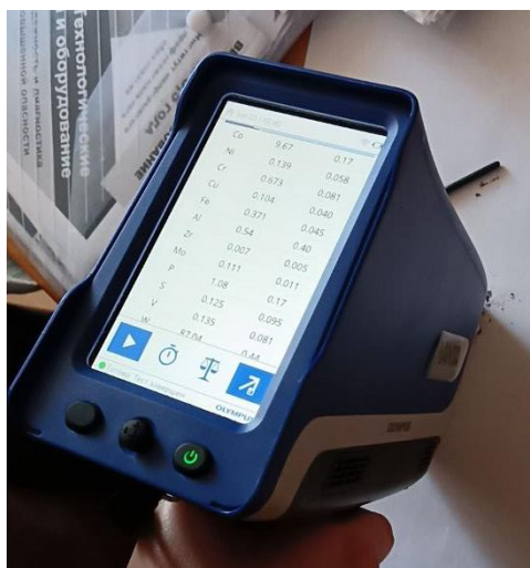
Рисунок 2 – Внешний вид рентгенофлуоресцентного анализатора Olympus Vanta серии C
