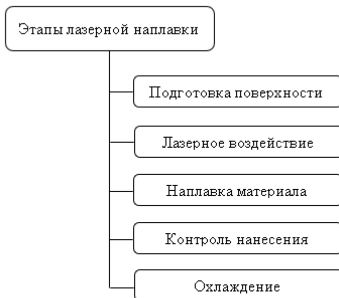
Рисунок 1 – Этапы лазерной наплавки
