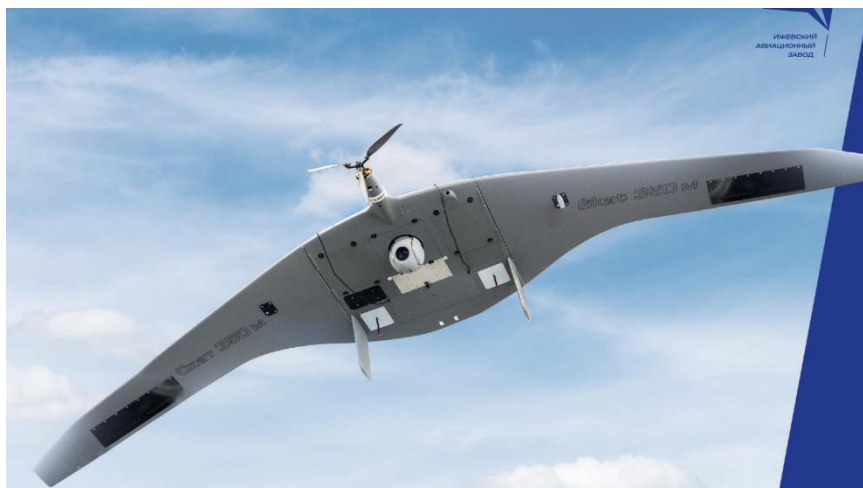
Рисунок 1 – Пример беспилотного летательного аппарата типа «летающее крыло» СКАТ 350М [1]
