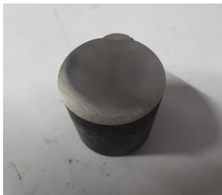
Рисунок 1 – Образец Нп-40Г после наплавки
