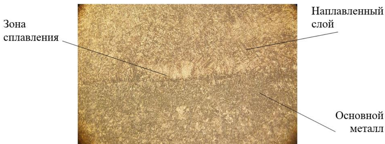
Рисунок 4 – После наплавки и отпуска х 200
