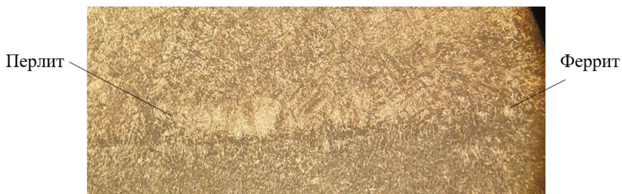
Рисунок 5 – Зона сплавления после отпуска
