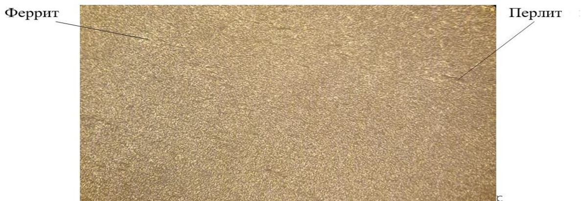
Рисунок 6 – Зона основного металла после наплавки
