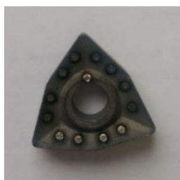
Рисунок 1 – Пластина после лазерной обработки
