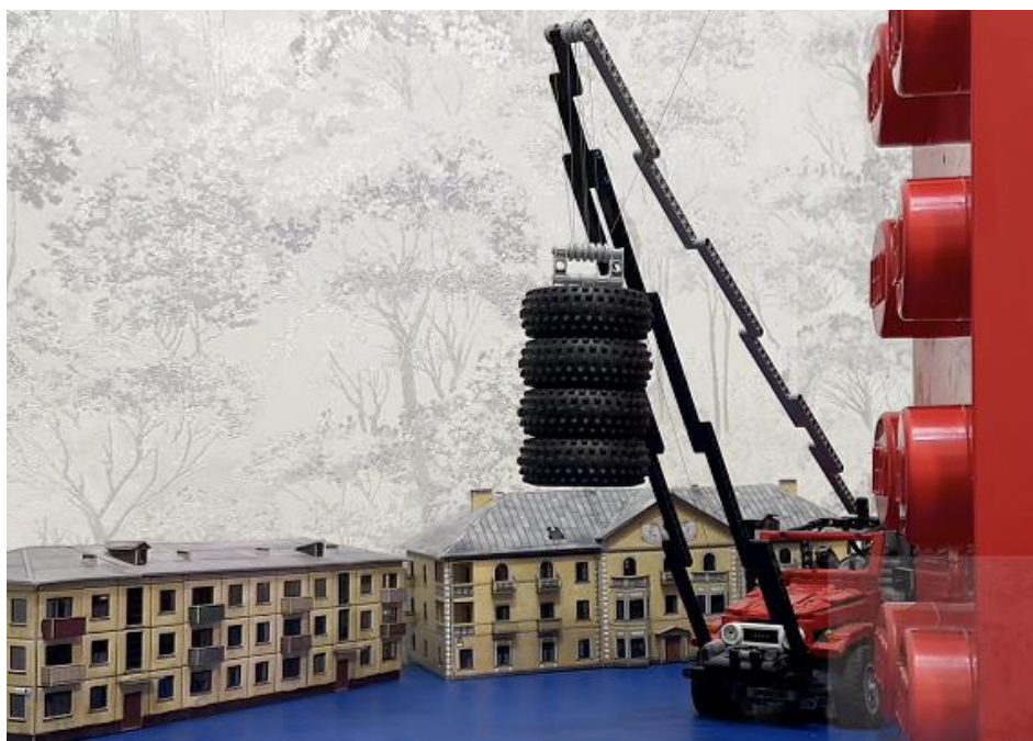
Рисунок 6 – Подъем груза через три пары блоков
