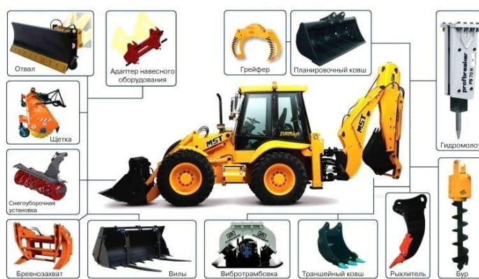
Рисунок 2 – Экскаватор с навесным оборудованием
