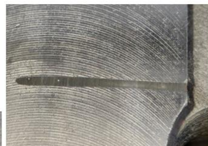
Дефект рабочего стола после ремонта
