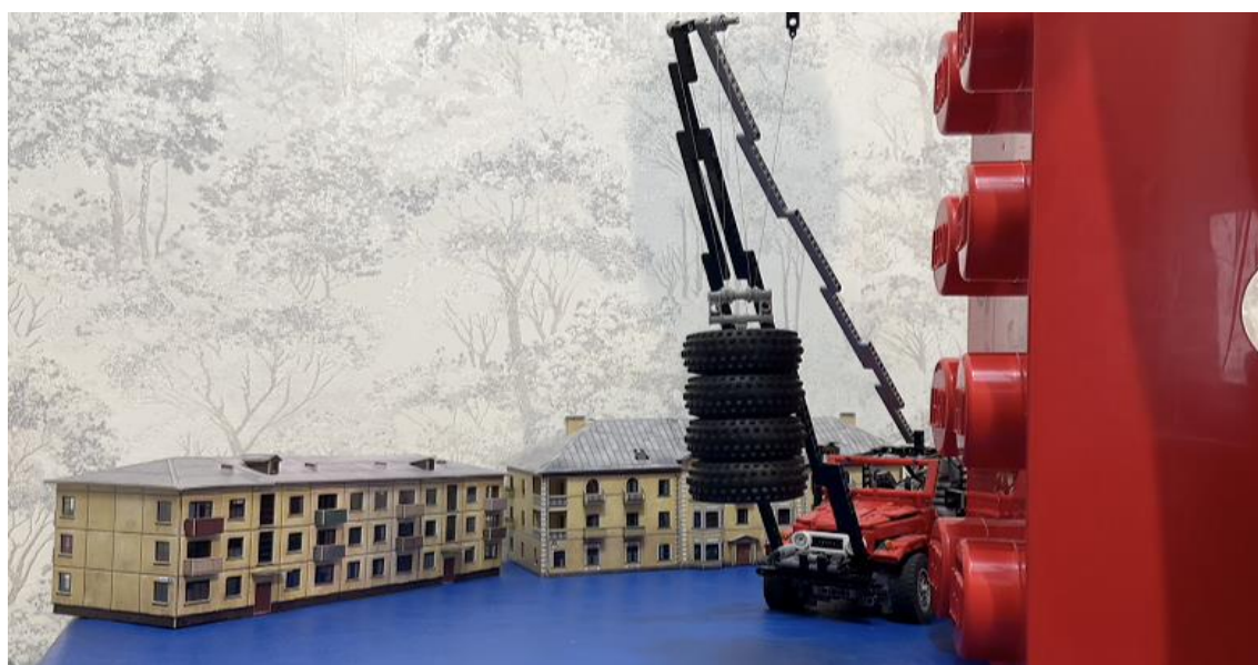
Рисунок 4 – Подъем груза через две пары блоков
