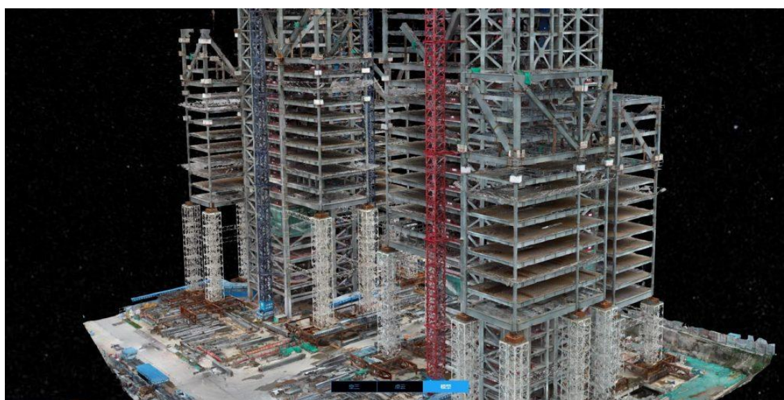
Рисунок 4 – Отсканированное здание системой LiDAR [12]
