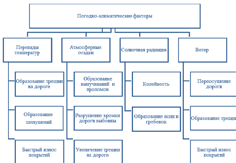
Рисунок 3 – Схема воздействия на дорожную конструкцию [7]
