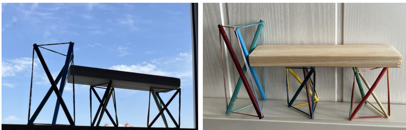
Рисунок 4 – Макет моста из модулей «тенсегрити», выполненный авторами статьи
