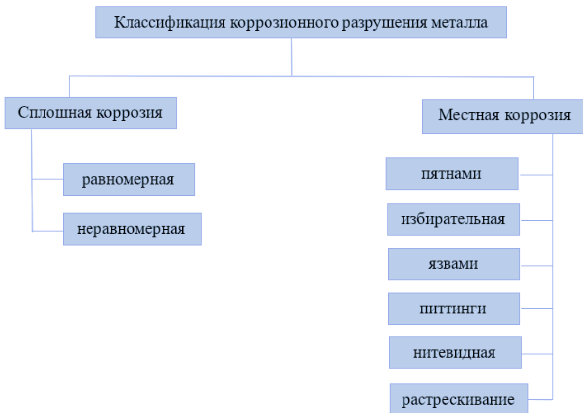
Рисунок 1 – Характер коррозионных разрушений
