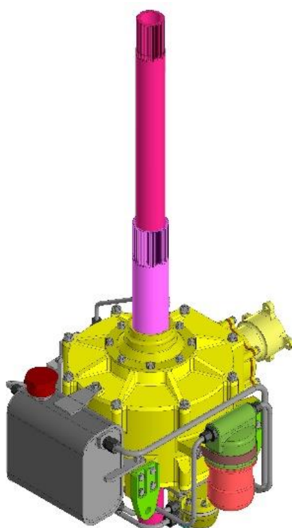
Рисунок 2 – Главный редуктор беспилотного летательного аппарата вертолетного типа соосной схемы
