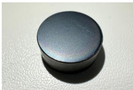
Рисунок 4 – Образец из быстрорежущей стали с покрытием
