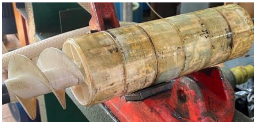
Рисунок 5 – Элементы проточной части после трех этапов испытаний
