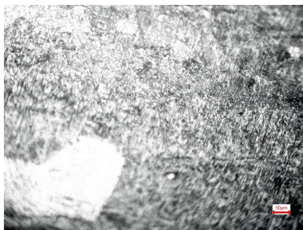
Рисунок 7 – Микроструктура образца после травления \times 400
