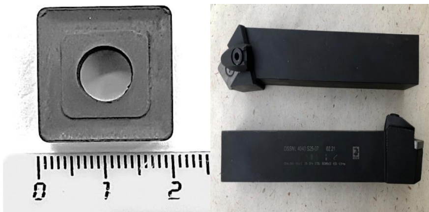
Рисунок 1 – Внешний вид четырехгранной пластины марки T14K8 и державки вместе с закрепленной пластиной
