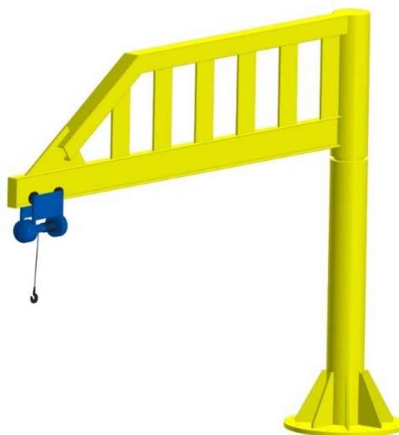
Рисунок 2 – 3D модель консольного поворотного крана
