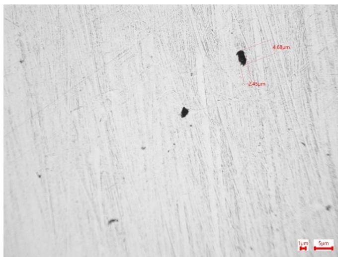
Рисунок 4 – Измерение величины пор в образце при увеличении x50
