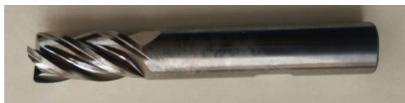
Рисунок 8 – Фреза с покрытием CVD
