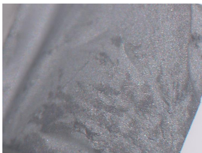
Рисунок 3 – Излом твердосплавного образца, \times 10
