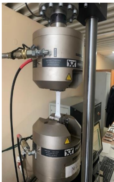
Рисунок 2 – Сервогидравлическая испытательная система Instron, модель 8801
