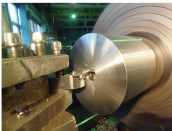
Рисунок 2 – Процесс торцевого точения на станке 16A16
