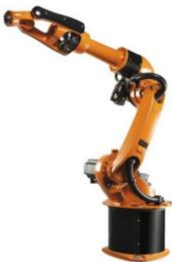
Рисунок 2 – Антропоморфный промышленный робот
