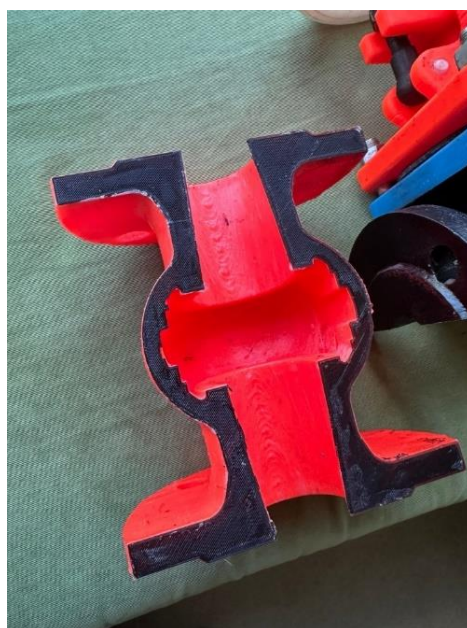
Рисунок 2 – Место разрыва корпуса
