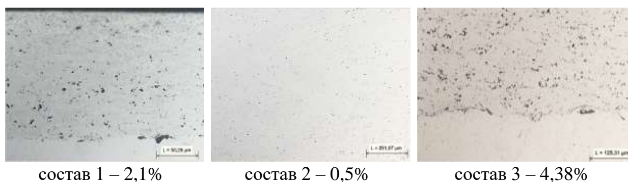
Рисунок 2 – Характер распределения пористости в анализируемых покрытиях
