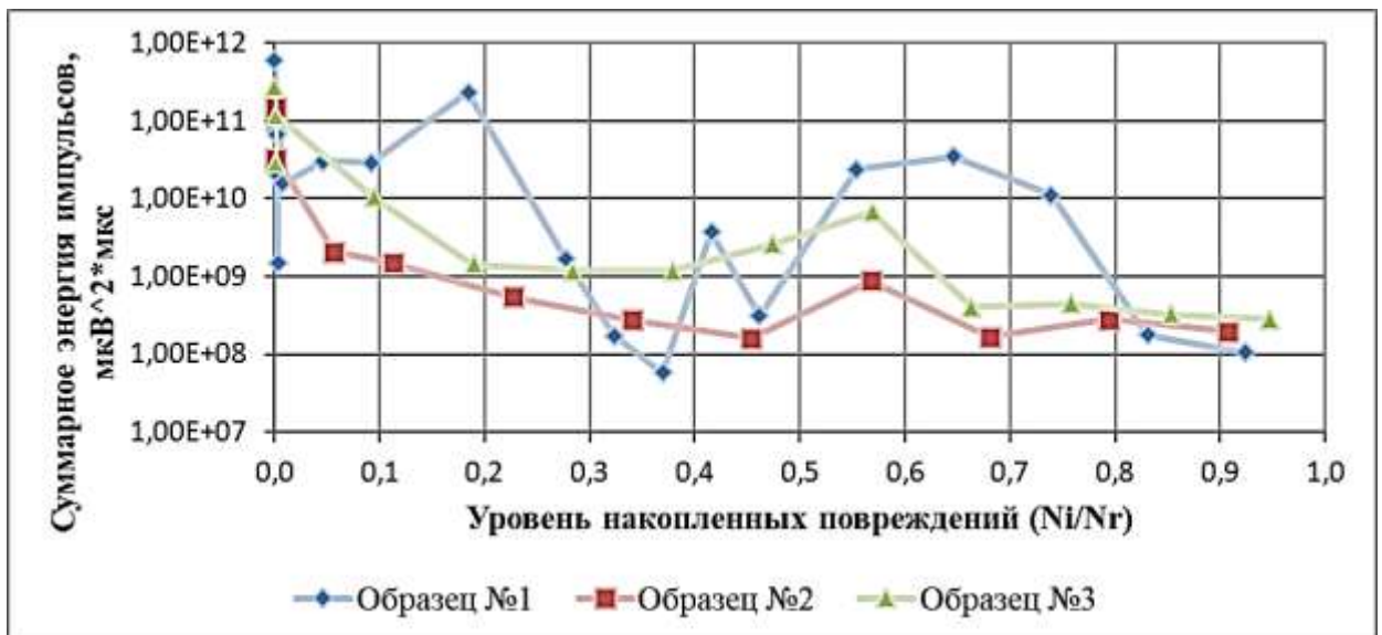
Рисунок 2 – Зависимость суммарной энергии импульсов АЭ от уровня накопленных повреждений
