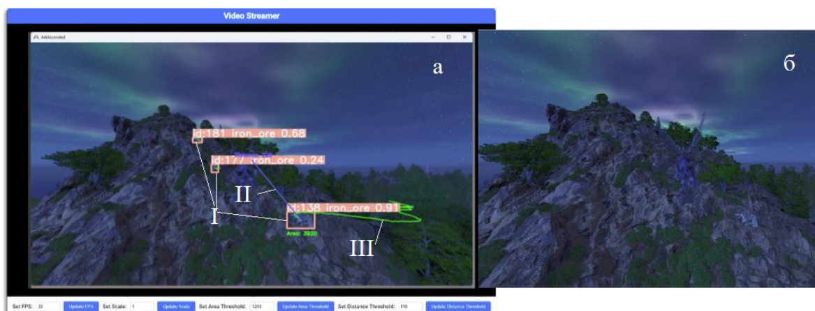
Рис. 1 – Пример приложения с элементами веб-интерфейса (а). (I) аннотированное изображение с объектами класса iron_ore . Линия (II) проведена от точки обзора до центра выбранного объекта; кривая (III) – оптимальная траектория движения до следующего объекта. Скриншот сессии без использования бота (б).
