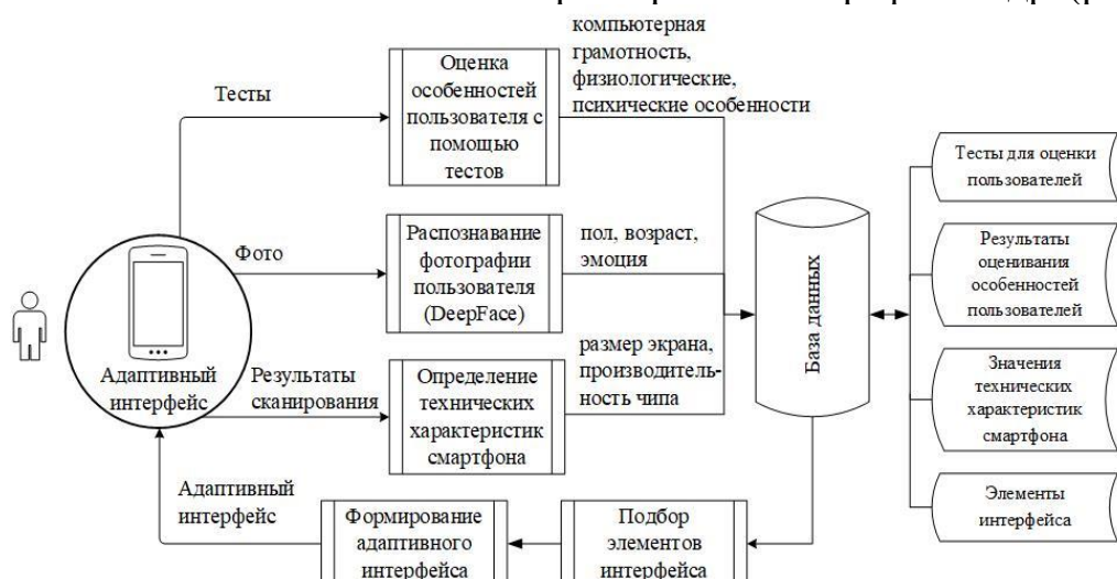
Рисунок 1 - Схема информационных процессов формирования адаптивного интерфейса мобильного приложения
